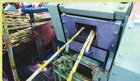
圧搾機で切断、粉碎して搾りだします
